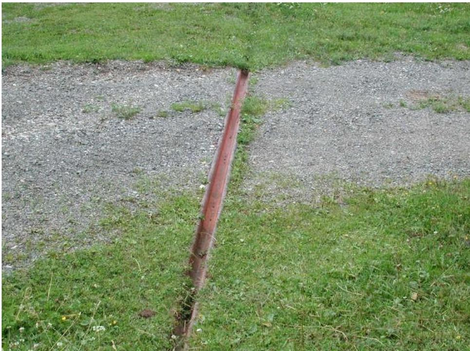
Für die Verwendung bei sehr schlechten Bodenverhältnissen können die Wasserspulen auf Wunsch mit zusätzlichen Ankerleisten geliefert werden.
